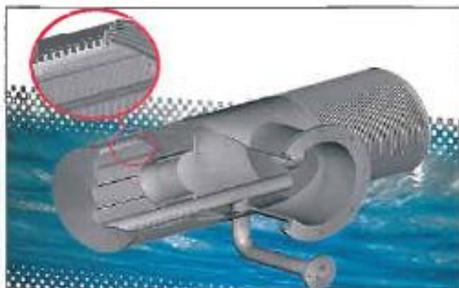
Figura 3.3.2-5 - Esquema tridimensional de la estructura de captación (Euroslot)
