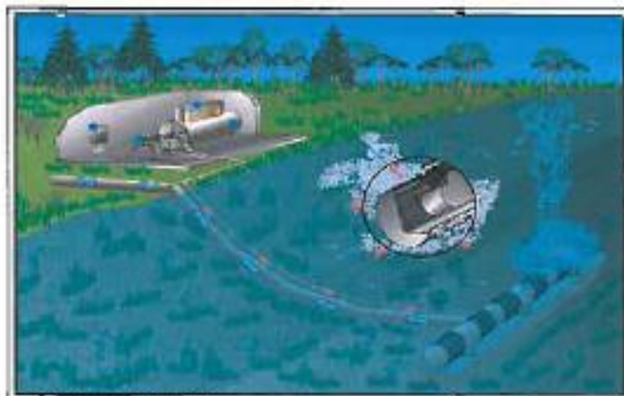
Figura 3.3.2-6 - Esquema conceptual del funcionamiento de la estructura de toma (Euroslot)
