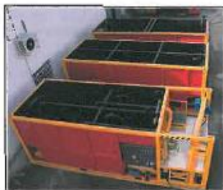
Foto 3.5.2-1 Tanques de mezclado y almacenamiento de lodos de perforación
